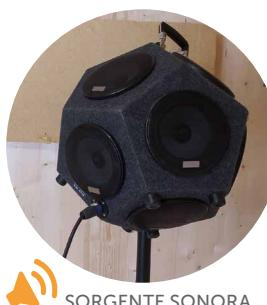
La misura si esegue attivando una specifica sorgente di rumore nell'ambiente emittente e misurando i livelli di pressione sonora in entrambi gli ambienti (emittente e ricevente). Il potere fonoisolante è dato dalla differenza dei due livelli misurati. Pertanto più il valore di  $R_w$  è alto, migliore sarà la prestazione di isolamento acustico della stratigrafia.
